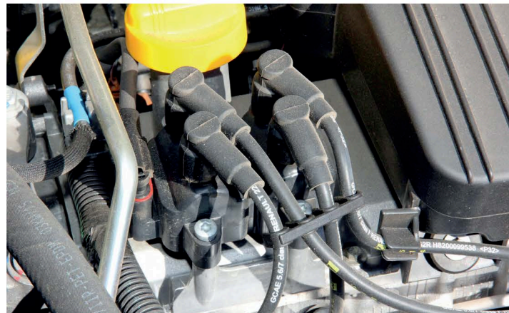
▲ Катушка зажигания представляет собой два двоянных повышающих трансформатора. Доступ к ней отличный – замена проста
