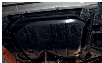
▲ Надежная заводская защита моторного отсека бережет картер и коробку
