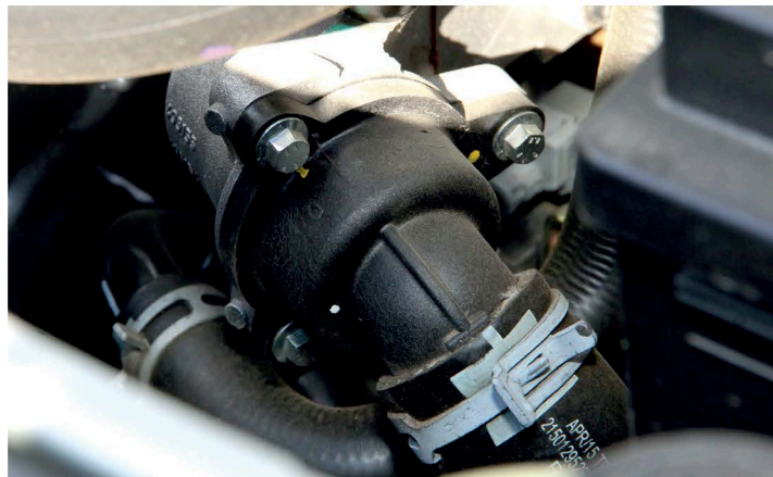
▲ К термостату системы охлаждения двигателя вопросов, как правило, не возникает. Замена узла не вызовет сложностей
