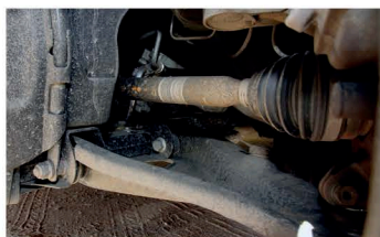
▲ После 100 000 км неисправный привод лучше заменить полностью
