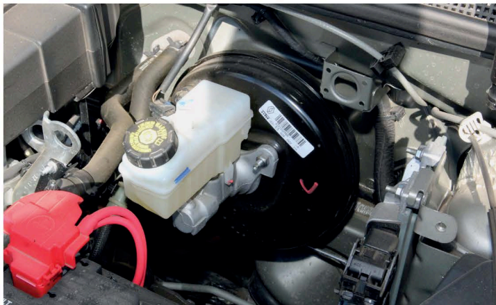
▲ Тормозная жидкость должна быть прозрачной. Если ее не меняли, согласно регламенту ТО, «тормозуха» будет темной
