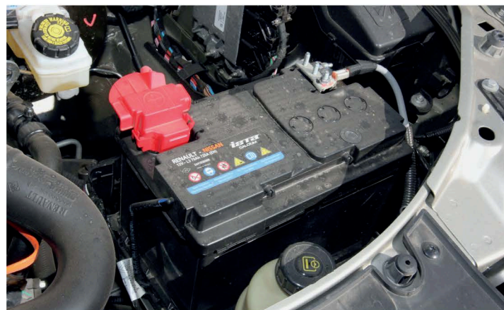
▲ Аккумуляторная батарея с пробками для контроля уровня электролита. При эксплуатации машины в городе следите за ее заряженностью!
