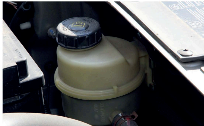
▲ Бачок гидравлического усилителя рулевого управления расположен у самых радиаторов возле аккумуляторной батареи
