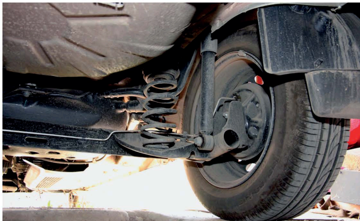
▲ Задняя подвеска автомобиля проще некуда – цельная балка, пружины и амортизаторы. Ремонт прост и относительно дешев
