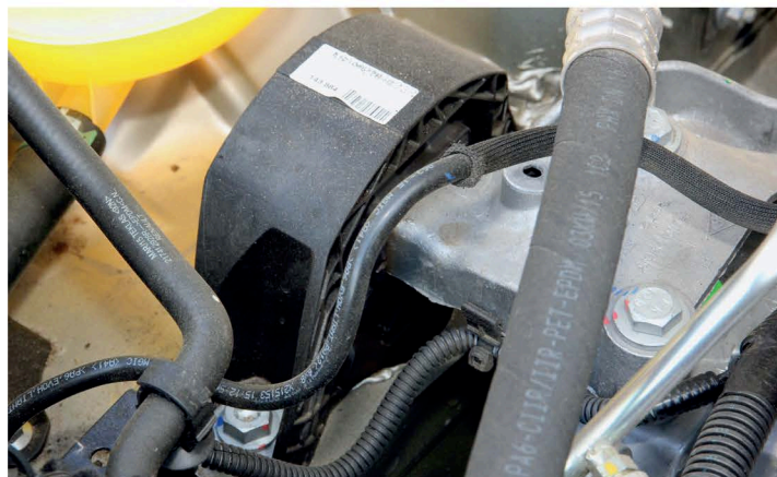
▲ Как свидетельствует опыт независимых СТО, при аккуратной эксплуатации автомобиля опоры двигателя выхаживают более 150 000 км
