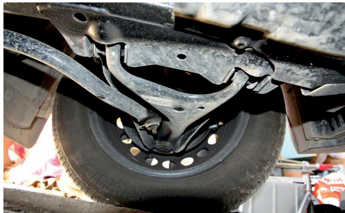
▲ У аккуратных автовладельцев нижние рычаги передней подвески (шаровые опоры и сайлентблоки) выходят более сотни тысяч километров!
