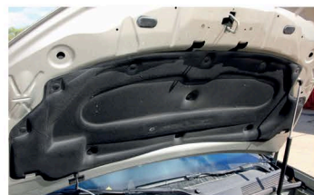
▲ Кучая шумоизоляция капота на уровень шума особо не влияет
