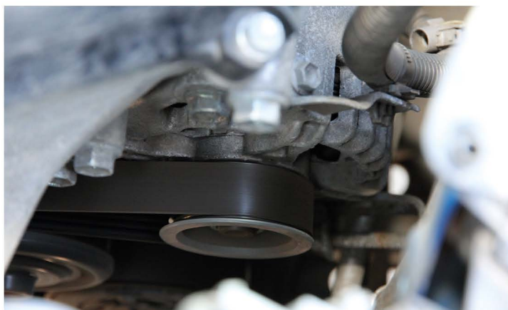
▲ Привод генератора автомобиля Peugeot 107 — надежный, широкий поликлиновый ремень. Такой «ходит» очень долго, даже в неблагоприятных условиях
