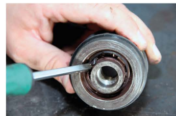
▲ При разрушении обгонной муфты часто происходит и обрыв ремня
