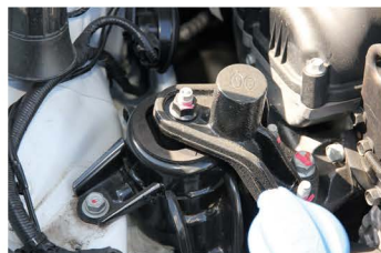
▲ При покупке машины обязательно проверьте состояние опор двигателя
