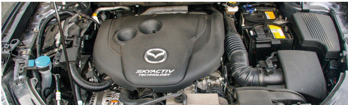
▲ Турбодизель Skyactiv обладает фантастически низкой для турбодизеля степенью сжатия. Обратная сторона: такой силовой агрегат требует только качественного топлива и практически непригоден для капитального ремонта
