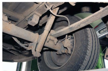
▲ Даже у требующего замены амортизатора может быть исправный вид
