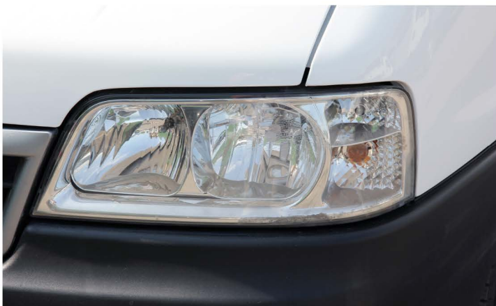
▲ После 4-5 лет интенсивной эксплуатации стекла фар головного света мутнеют из-за пескоструйной атаки
