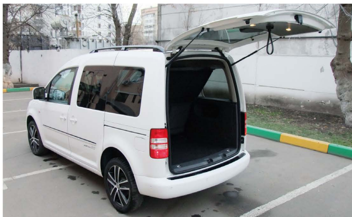
▲ Задняя дверь открывается вверх - это может усложнить погрузку и разгрузку. Для «просто» Caddy можно заказать распашные двери
