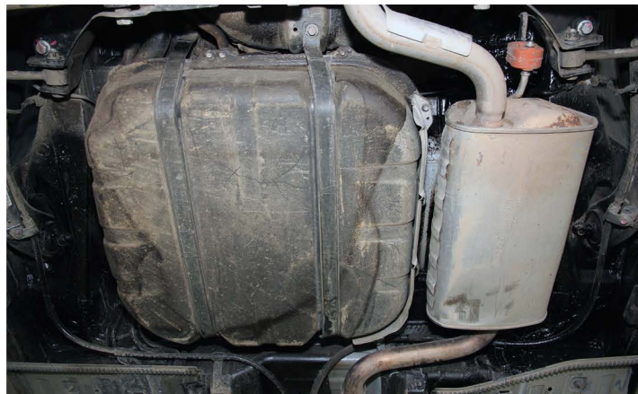
▲ Бензобак не имеет защиты снизу – на проселке его можно пробить
