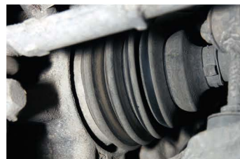
▲ Пыльники ШРУСов с микротрещинами — срочно меняйте
