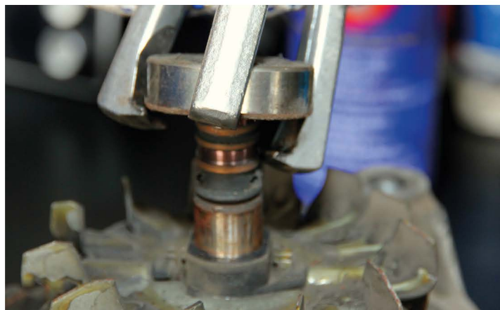
▲ Загудевшие опорные подшипники демонтируются с вала специальными двух- и трехлапковыми съемниками
