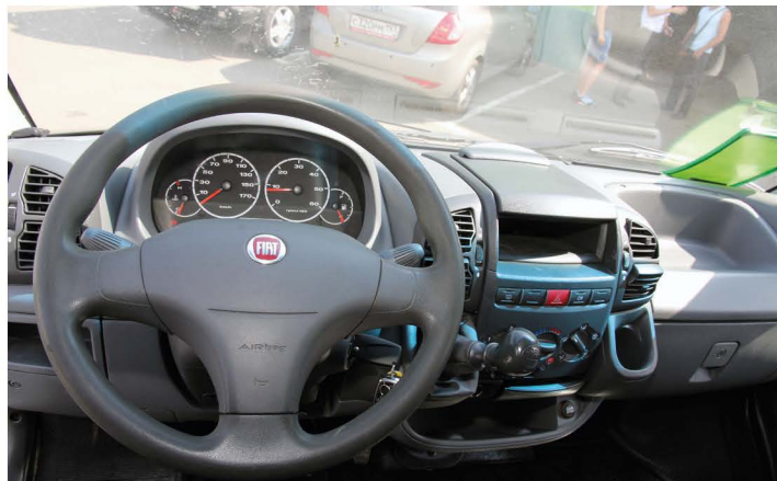
▲ Приборный щиток прост и легко читаем. Рычаг управления коробкой передач находится на консоли
