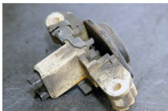
▲ Изношенные щетки — виновники снижения эффективности работы узла
