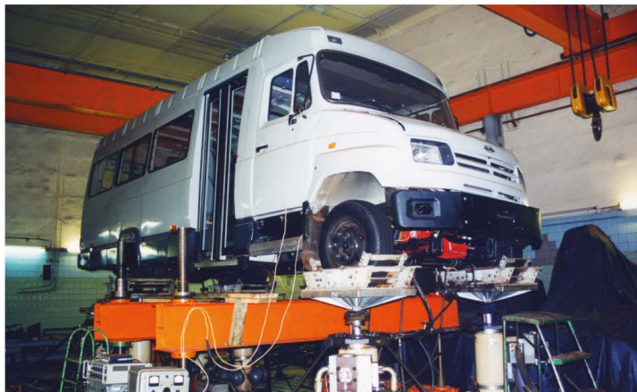
▲ Элементы подвески тестируются на специальном вибростенде, здесь подбирают характеристики амортизаторов, проверяется их стойкость к нагрузкам
