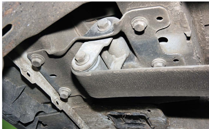
▲ Помните, что в «серьгах» заднего крепления рессор необходимо заменить пару сайлентблоков, а не только те, что впрессованы в «уши» рессоры
