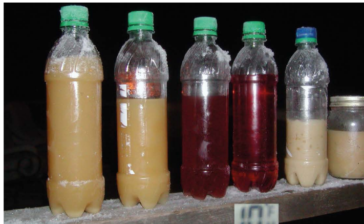
▲ При образовании парафинов топливо может практически полностью потерять текучесть
