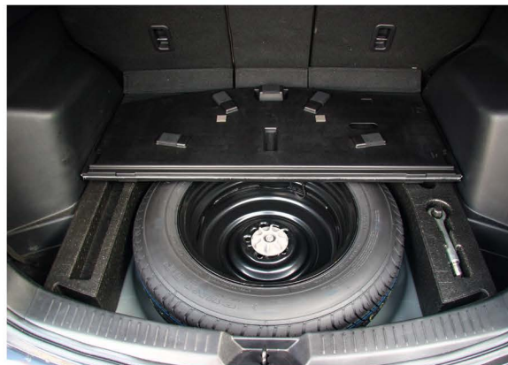
▲ Докатка, размещенная под фальшполом, «съела» немного полезного пространства багажника
