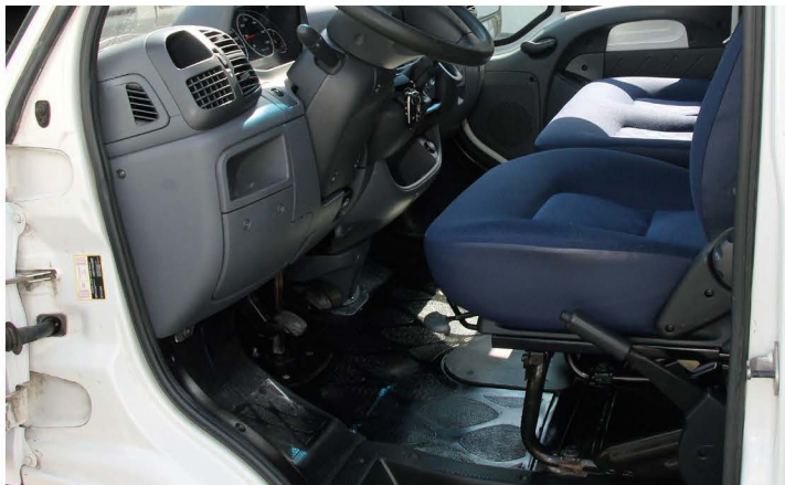
▲ Обратите внимание на расположение рукоятки привода ручного тормоза – он слева от водительского места
