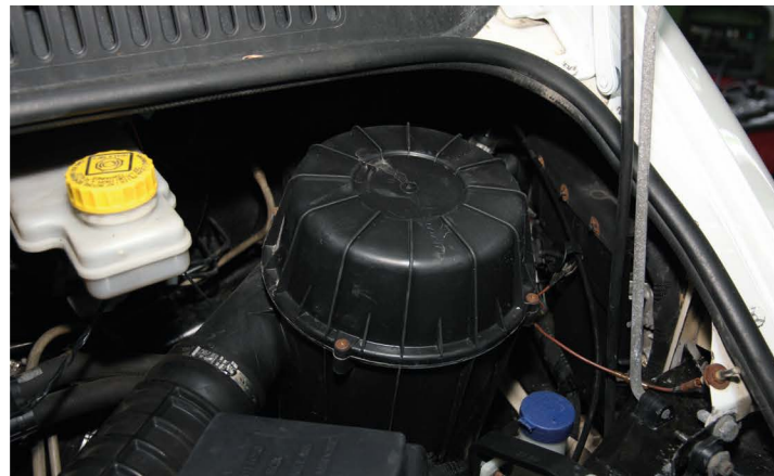
▲ Корпус воздушного фильтра в прямом доступе, так что замена элемента не вызывает сложностей
