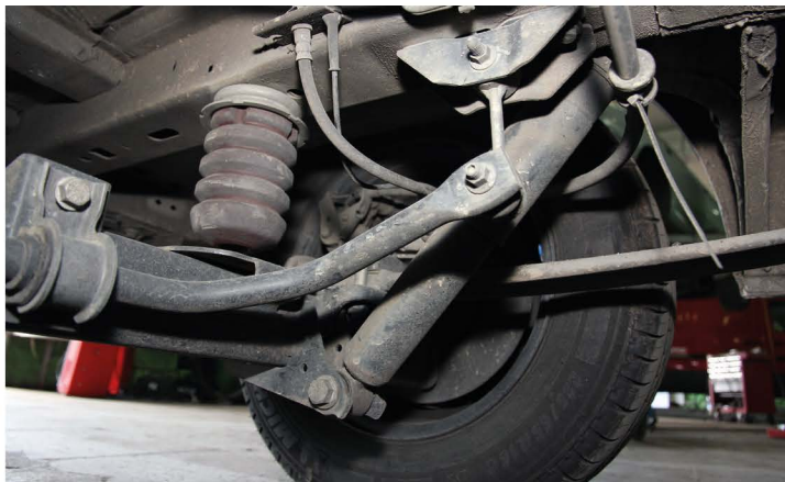
▲ В задней подвеске Renault Master помимо сайлентблоков есть стабилизатор и «косточки», которые также требуют внимания
