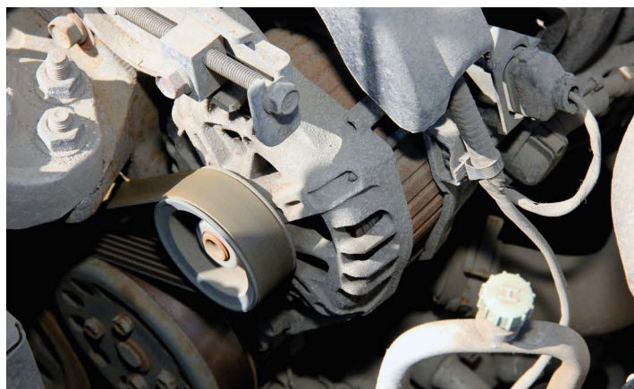
▲ Доступ к генератору автомобиля Hyundai i30 отменный. Механизм натяжения приводного ремня прост и понятен
