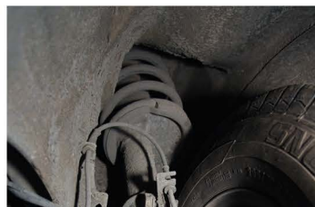
▲ Передняя подвеска с амортизаторами. Убедитесь в отсутствии потеков
