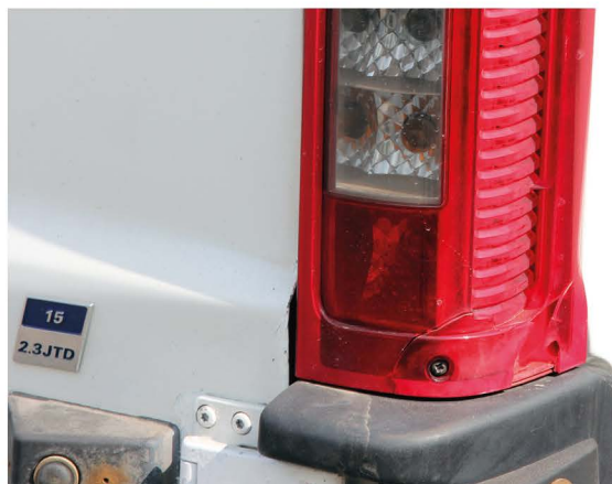
▲ Покровное стекло фонаря с трещиной – не беда. Ремонт с применением эпоксидной смолы быстр и не затратен
