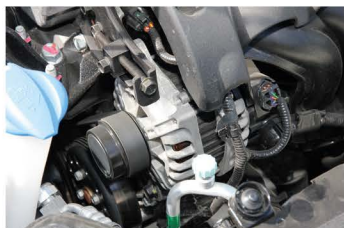
▲ Привод генератора: надежный и износостойкий поликлиновый ремень
