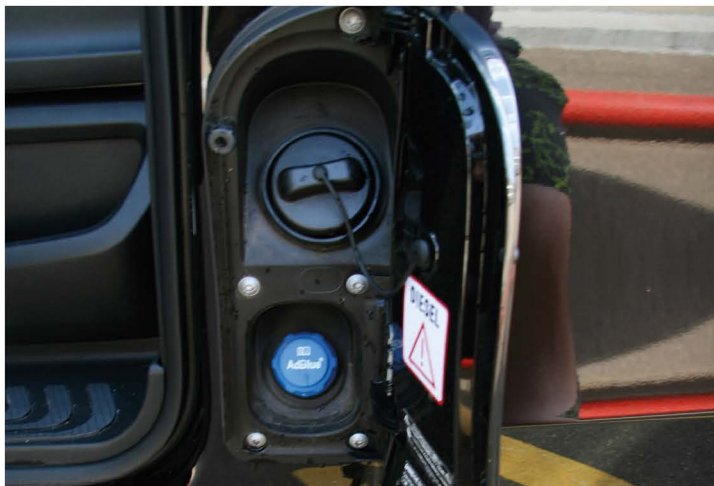
▲ У нового Mercedes-Benz V-Class две заправочные горловины: одна для солярки, вторая — для AdBlue
