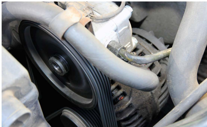
▲ Генератор под капотом машины Volvo S60 (2,4). Его корпус в следах масла, которое сочится из расположенного сверху агрегата
