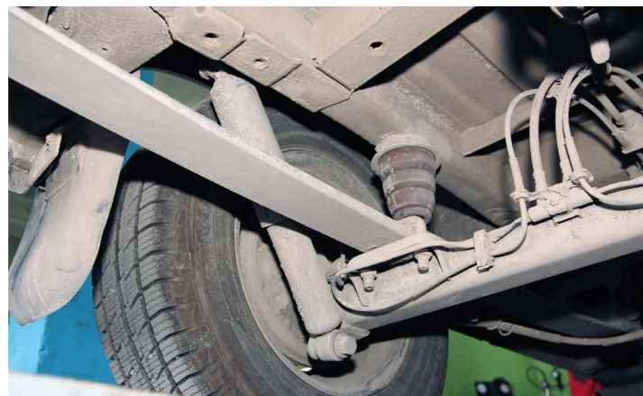
▲ Задняя подвеска простая и ремонтпригодная — балка, притянутые к ней стрейчками однолистовые рессоры и гидравлические амортизаторы
