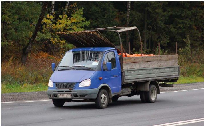
▲ При таком распределении нагрузки, подвеске передней, рулевой оси, достается по полной программе
