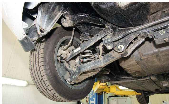
▲ Задняя подвеска в угоду управляемости и комфорта рычажная. Следите за состоянием сайлентблоков
