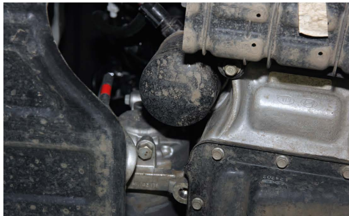
▲ Откручивать фильтр удобно специальным трехлапчатым или чашечным съемником
