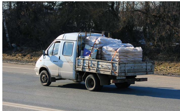
▲ В данном случае амортизаторы, скорее всего, уже «мертвые», как и рессоры с сайлентблоками. Перегруз приводит к ускоренному износу подвески
