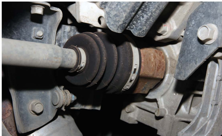
▲ При покупке машины осмотрите состояние защитных чехлов ШРУСов. Трещины или разрывы повод попросить скидку в 5000 руб.
