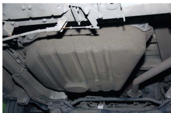
▲ Топливный бак снизу ничем не прикрыт — аккуратнее на грунтовках!
