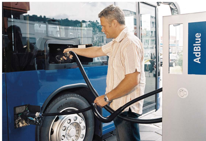
▲ В коммерческий транспорт с дизельными двигателями (грузовики и автобусы) уже давно заправляют раствор мочевины (AdBlue)
