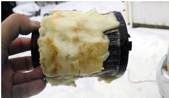
▲ Спасти этот топливный фильтр уже не удастся - он полностью засорен парафинами, которые образовались от морозов
