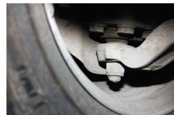
▲ Шаровая с пальцем направленным вниз — вырвать такую сложно
