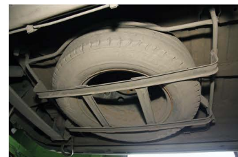
▲ Запасное колесо уложено в «корзину» и крепится снизу грузовика
