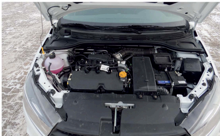
▲ Подкапотное пространство неплохо защищено от летящей грязи. Единственное слабое место находится в районе язычка замка
