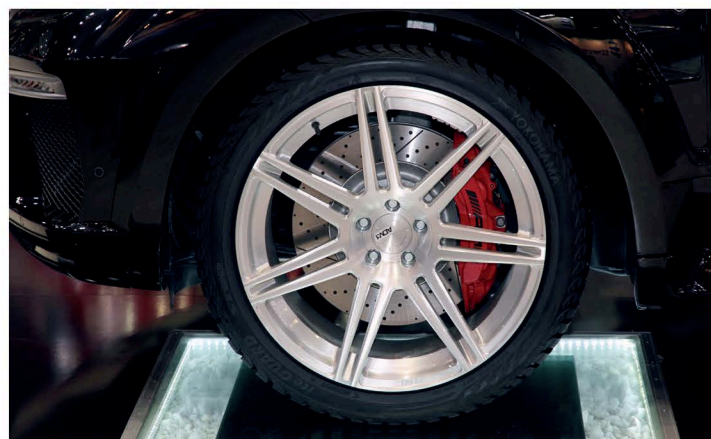
▲ Колесные диски не должны препятствовать вентиляции тормозных узлов. В противном случае произойдет перегрев дисков и колодок
