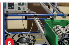
6. Все без исключения насосы дважды проходят проверку на возможность появления течи. Первый тест на наличие в заготовке раковин и пор проводится до начала процесса её механической обработки, следующий — после установки торцевого уплотнения «KACO»
