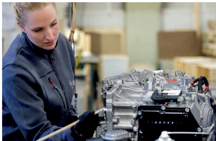
▲ ...но без человеческого участия в этом процессе не обойтись - каждую деталь нужно дефектовать
