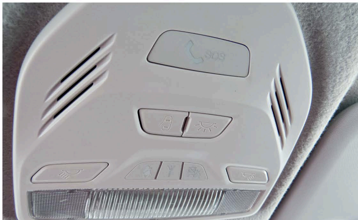
▲ В верхней части плафона освещения находится кнопка вызова спасателей. Диспетчер отвечает в течение 5 с, но баловаться с ней не рекомендуем
