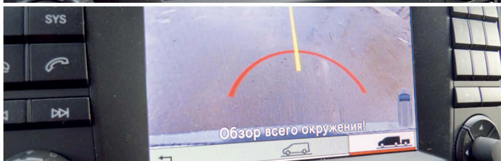
▲ Камера имеет два варианта. Первый (вверху) для обычной парковки задним ходом, второй (внизу) для облегчения парковки с прицепом
