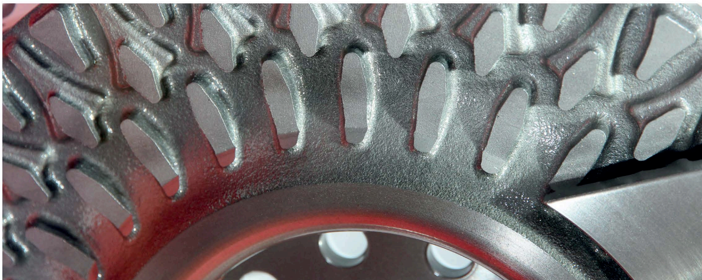
▲ Вентилируемый тормозной диск в разрезе. Как видим, для улучшения сема тепла воздух проходит не по прямой, а по сложной траектории. Такие тормозные диски позволяют тормозам работать стабильно даже при высоких тепловых нагрузках
