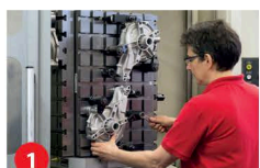
1. Литые заготовки корпусов насосов обрабатываются на современных металлорежущих станках с использованием высокоточного твердосплавного режущего инструмента и оснастки
