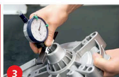
3. Посадочные места подшипников измеряются исключительно вручную при использовании технологии цифрового измерения. Только в том случае если допуски в точности соблюдены, насос будет собран и сможет прослужить долго
