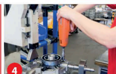
4. Из соображений снижения себестоимости и повышения производственной эффективности уплотнительная заглушка запрессовывается в процессе механической обработки. По тем же соображениям шильдик и электромагнит устанавливаются на этом же этапе
