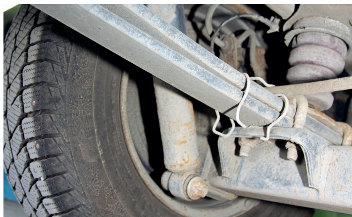
▲ Рессоры задней подвески состоят из двух листов. При работе машины с перегрузом амортизатор долго не проживет
