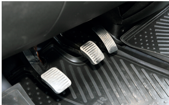
▲ Педальный узел с подвесными педалями. По состоянию их накладок можно косвенно судить о пробеге автомобиля
