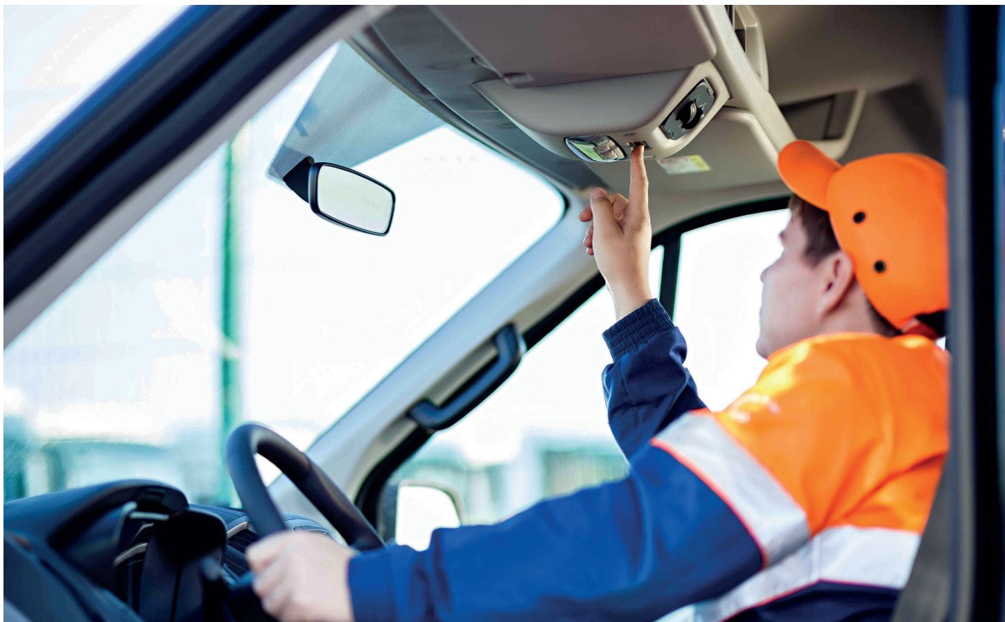
▲ Ford Transit российской сборки получил «облегченную» версию ЭРА-ГЛОНАСС: она не может связаться автоматически со спасателями, это может сделать только водитель или пассажир, нажав кнопку SOS
