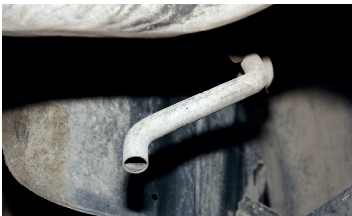
▲ Трубка отвода выхлопных газов от агрегата автономного подогрева двигателя. «Автономка» позволит пустить дизель даже в лютые морозы
