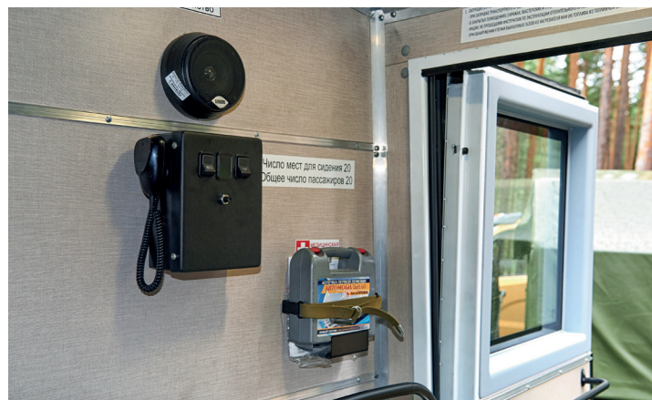
▲ Связь с водителем обеспечивается через интерком. Причем водитель может наблюдать за происходящим в салоне благодаря камере
