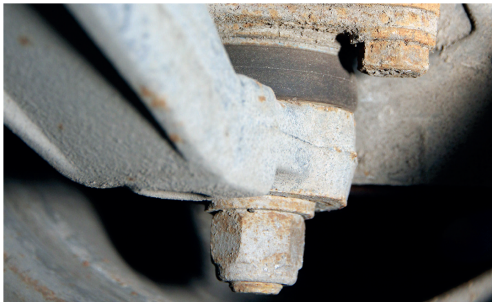
▲ Нижние рычаги кованые. Сломать их даже на плохой дороге практически не реально. Шаровые опоры ориентированы пальцем вниз
