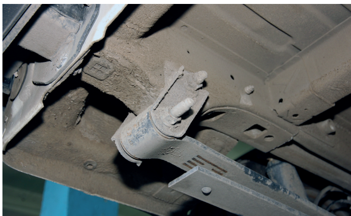
▲ В «уши» рессор и «серег» запрессованы надежные резинометаллические шарниры. Обслуживать их не требуется
