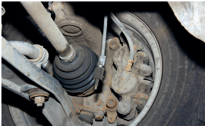
▲ Обязательно осмотрите состояние защитных чехлов шарниров приводного вала. Следы масла (см. фото) говорят о наличии трещин
