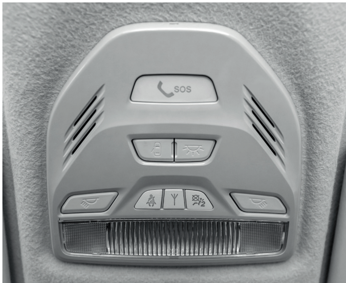
▲ Нажав на кнопку SOS, расположенную на потолочной панели, пассажиры могут сами связаться с экстренными службами
