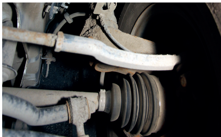
▲ Передняя подвеска типа McPherson вкупе с точным рулевым механизмом реечного типа — залог хорошей управляемости машины
