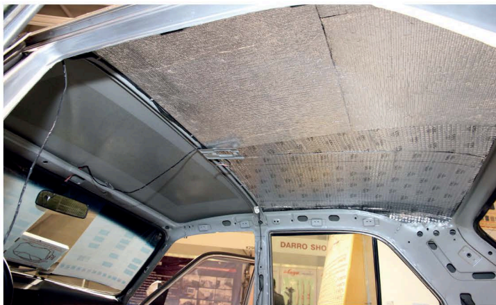
▲ Обработка крыши есть наиболее ответственная операция. Материалы должны иметь великолепную адгезию, небольшую массу и держаться мертвой хваткой
