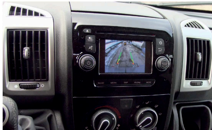
▲ Мультимедийный центр оснащен 5-дюймовым сенсорным дисплеем. Также на него выводится изображение с камеры заднего вида
