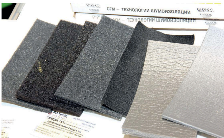
▲ Звукопоглощающие материалы имеют пористую структуру и напоминают мелкоячеистый поролон. Однако при этом поры расположены хаотично, а не ориентированы по цепочке
