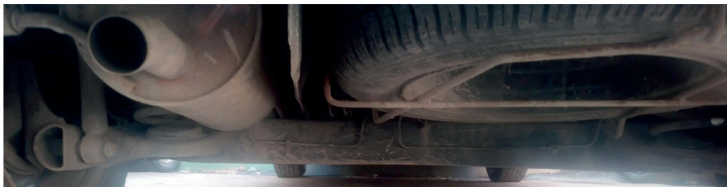
▲ Запасное колесо хранится под кузовом, добраться до него не просто
