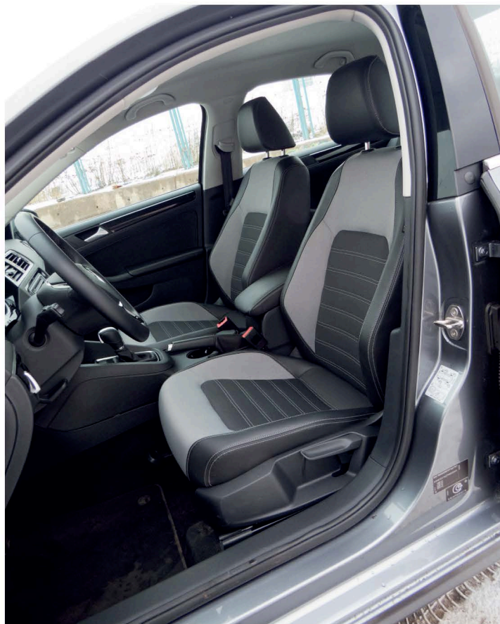
▲ Передние сиденья имеют неплохую боковую поддержку, водительское оснащено регулировкой по высоте
