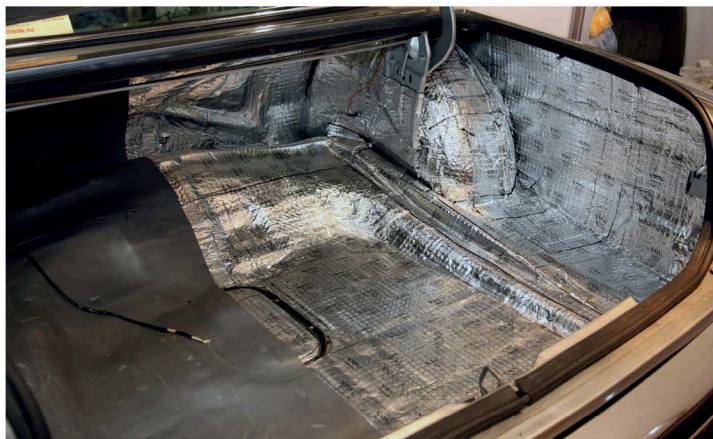
▲ Эффективная шумоизоляция представляет собой самый настоящий пирог из нескольких слоев различных материалов
