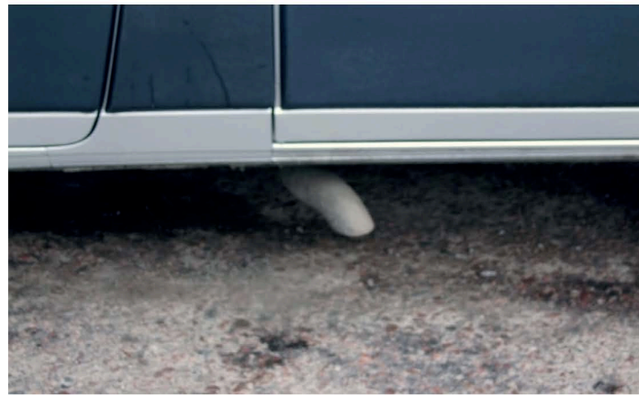
▲ Патрубок системы выхлопа справа по борту — очень спорное и непрактичное решение
