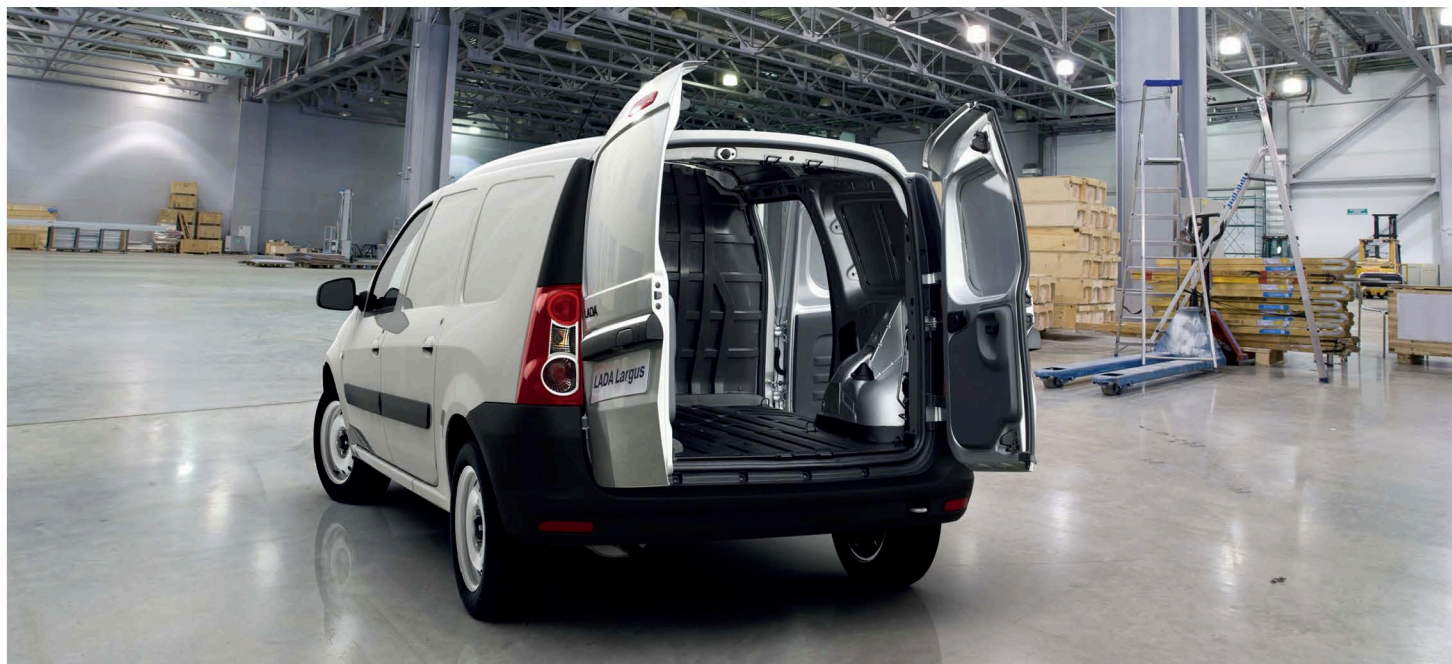
▲ Распашные двери имеют асимметричную пропорцию - левая шире правой. Это облегчает доступ в кузов. Боковые двери здесь оставлены открывающимися вбок, а не сделаны сдвижными
