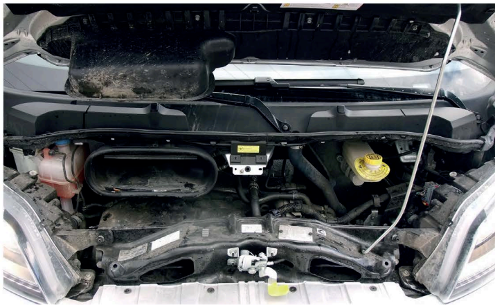
▲ Турбодизель Iveco F1A мощностью 130 л.с. достаточно активно тянет Fiat во всех диапазонах и даже с полной загрузкой
