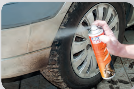
Битум сразу же начинает стекать. Но если потеки застынут, потребуется повторная обработка
