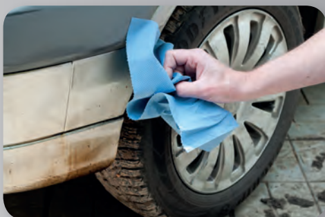
Битум сразу же начинает стекать. Но если потеки застынут, потребуется повторная обработка
