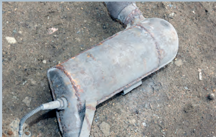
Обратите внимание на то, что при электронной схеме, предусматривающей получение информации ЭБУ о концентрации кислорода в отработавших газах от одного, установленного до каталитического нейтрализатора датчика, можно безболезненно удалить сотовый блок. Если же в системе выпуска два «лямбда-зонда» и катализатор удаляется, то для адекватной работы мотора потребуются корректировка («перепрошивка») алгоритма работы ЭБУ.
