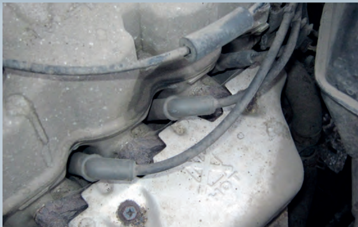
Тепловой экран, мешавший демонтажу «лямбда-зонда», на данном моторе пришлось демонтировать. В итоге болты, его крепящие, были сорваны. Ремонт с высверливанием остатков, нарезанием резьбы занял 40 минут.
