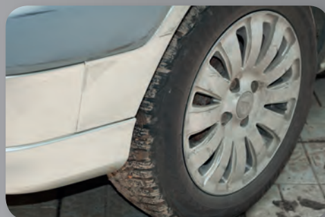
Битум сразу же начинает стекать. Но если потеки застынут, потребуется повторная обработка
