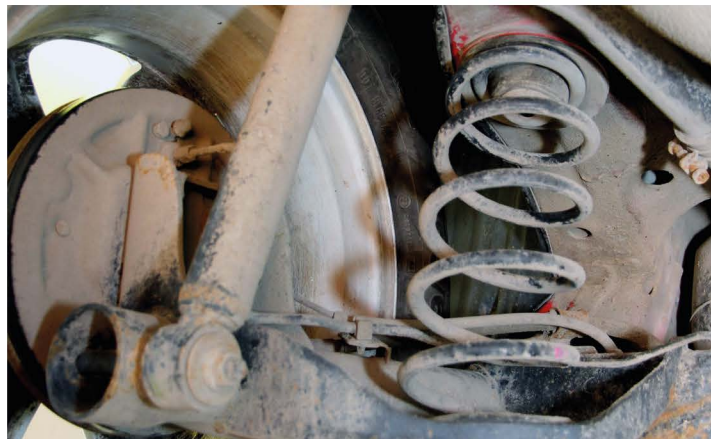
▲ Если пробег перевалил за 50 000 километров проверьте нет ли потеков масла на корпусах задних амортизаторов. В целом же задняя подвеска простая и надежная
