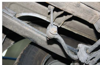
▲ При обслуживании проверяйте состояние подушек стабилизатора
