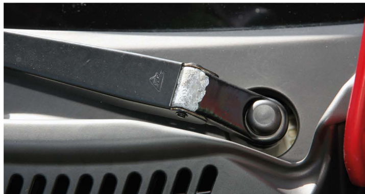
▲ Поводки дворников на четырехлетней машине облезли. Кто виноват – агрессивная среда или несоблюдение технологии окраски?
