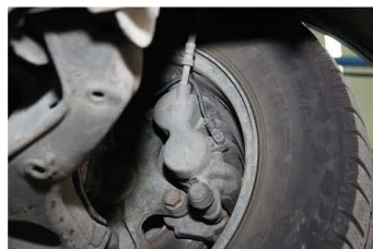
▲ При замене тормозов подвижность суппорта и проводку датчика износа
