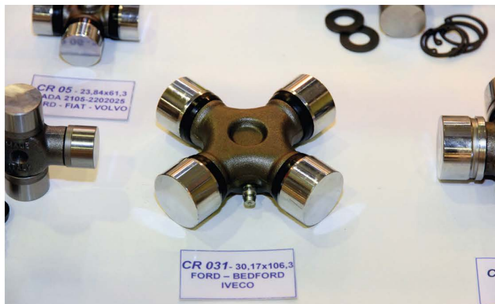
▲ При ремонте заменяются все подшипники и крестовины. Именно этим в частности достигается высокая надежность и ресурс отремонтированного вала
