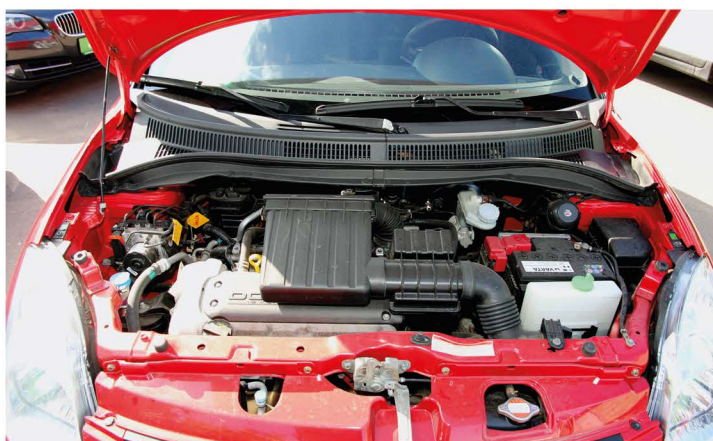
▲ Компоновка моторного отсека очень плотная. Доступ к ряду узлов и агрегатов ограничен, что затрудняет ремонт и обслуживание малолитражки
