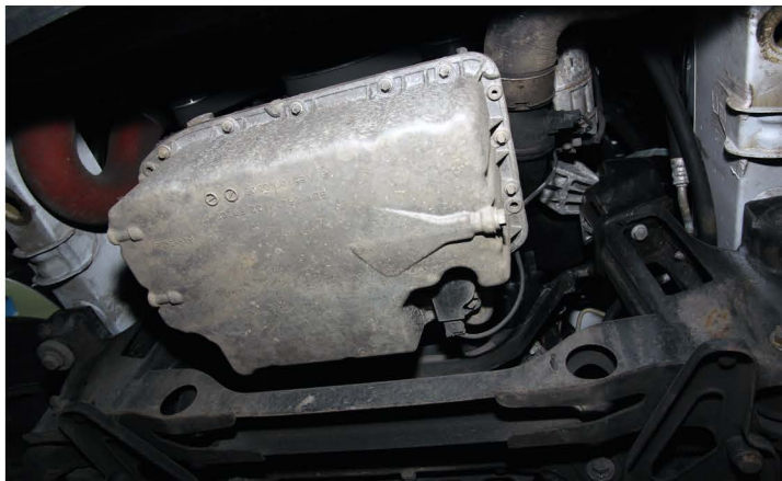
▲ Неприкрытый стальной защитой картер для грузовика с низким дорожным просветом есть недостаток
