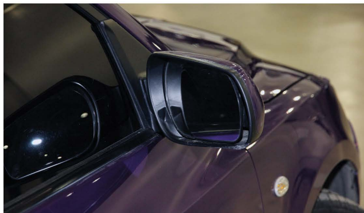
▲ Если в щель между корпусом и зеркальным элементом попадет мокрый снег и там замерзнет, при активации привода регулировки его можно сломать
