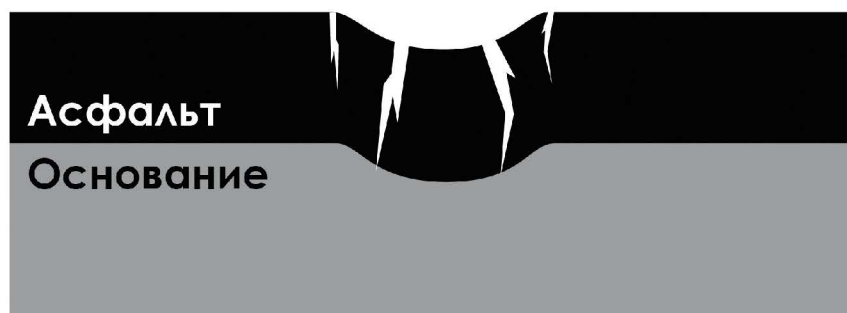
▲ В конце концов покрытие обваливается в полость, формируя выбоину
