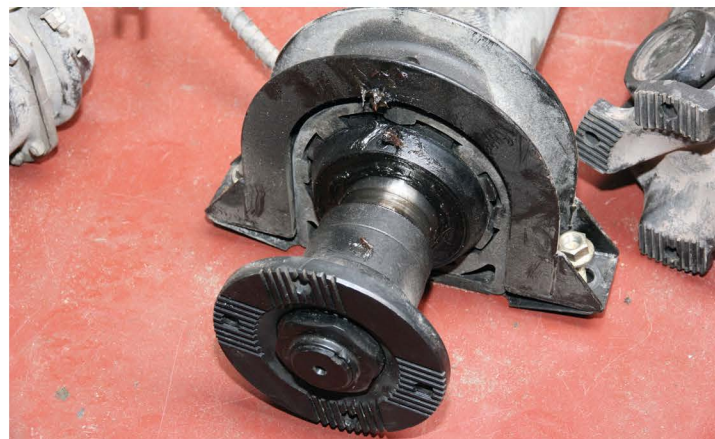
▲ Подвесной подшипник при ремонте карданной передачи заменяется вместе с крестовинами. При модернизации передачи опору могут исключить
