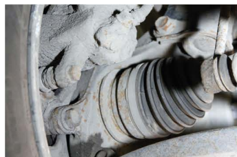
▲ Обязательно проверьте нет ли трещин и разрывов в чехлах ШРУС
