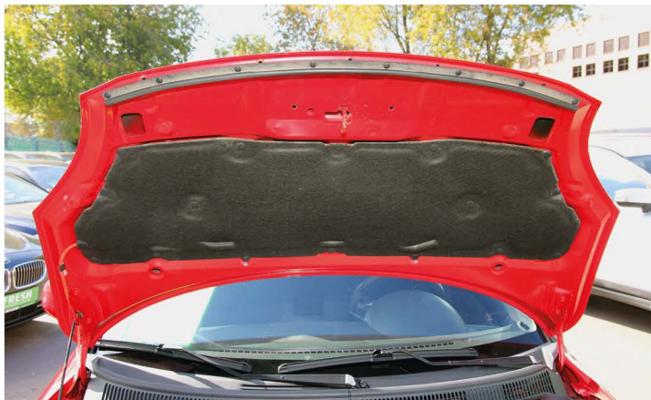
▲ Мат шумоизоляции капота – это очень хороший заслон шумам идущим от мотора. Однако в целом «шумка» салона могла быть и эффективнее
