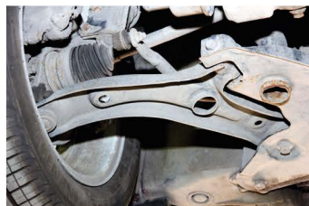
▲ Неоригинальные рычаги передней подвески обойдутся в 2100-2200 руб.
