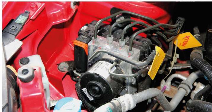
▲ К блоку антиблокировочной системы, как правило, вопросов не возникает. А вышедший из строя заменить не сложно – доступ к агрегату хороший
