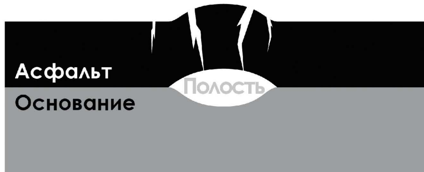
▲ Лед тает, оставляя полость, которая снова заполняется водой и увеличивается после каждого значительного перепада температур
