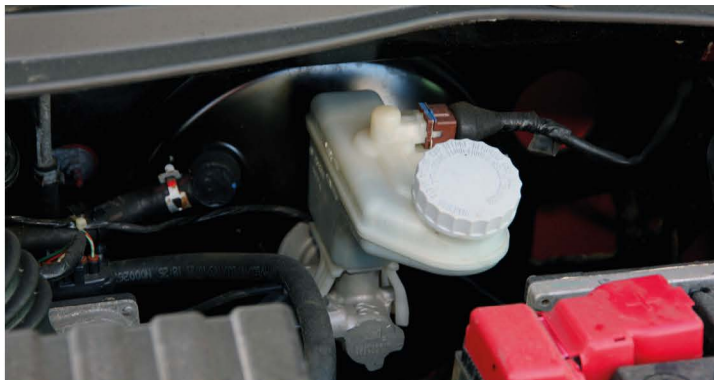
▲ Обязательно проверьте уровень и цвет тормозной жидкости. Старая – темного цвета. В такой много воды, а значит, не исключена коррозия тормозной системы
