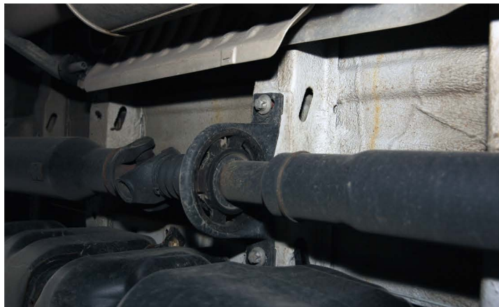
▲ В подвесной опоре карданного вала важно не только состояние подшипника (шумы и люфты) но и резинового демпфера (разрывы и трещины)
