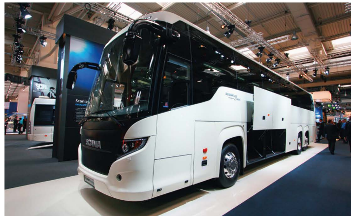
▲ Вынесенные на L-образных консолях элементы зеркал автобусов имеют и обогрев и антибликовое покрытие, а корпуса обладают отменной аэродинамикой
