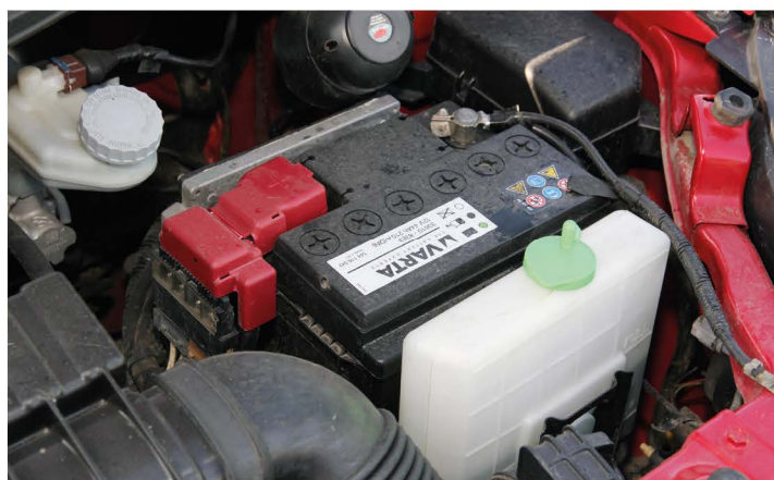
▲ Пятно жидкости на крышке аккумулятора аккуратно расположено напротив крышки бачка. Вопрос — откуда это пятно взялось? Получите на него ответ до покупки автомобиля
