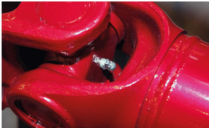
▲ Ресурс подшипников зависит от регулярности смазки и применяемых для этого масел. Перед шприцеванием пресс-масленку необходимо очистить от грязи
