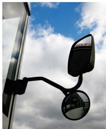
▲ Бюджетное исполнение — дуэт из двух зеркал. Круглая сфера позволяет контролировать зону бордюра, а прямоугольный элемент выполняет основную функцию
