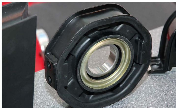
▲ В подвесной опоре важно не только качество подшипника, но и качество резинового демпфера. Последний должен выдерживать и морозы, и жару
