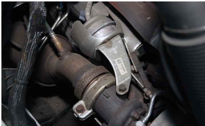
▲ Несвоевременная замена моторного масла очень быстро прикончит дорогостоящую оригинальную турбину
