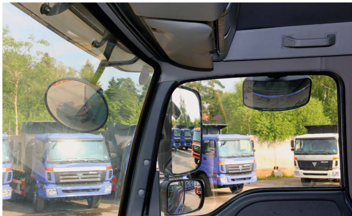
▲ Для полноценного обзора грузовики оснащаются несколькими зеркалами, разной формы. В данном случае «гирлянда» состоит из четырех элементов
