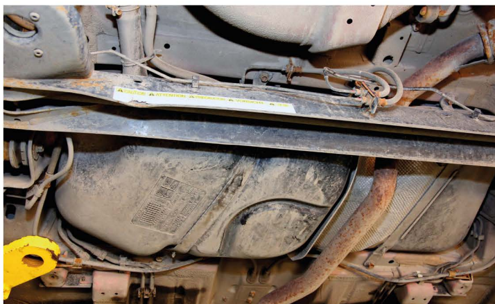
▲ Балка замята при наезде на препятствие. Дорожный просвет у Swift не для грунтовок. Бак в районе трубы выхлопной системы отгорожен тепловой защитой
