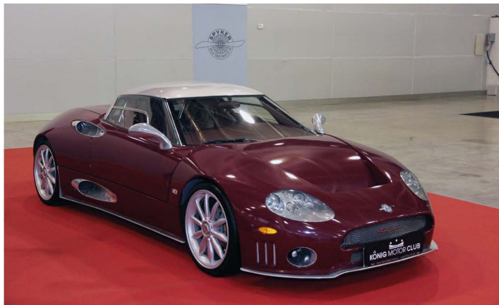
▲ Для спортивных автомобилей, имеющих продуманную аэродинамику кузова, зеркала установлены в корпуса, обеспечивающие минимальное сопротивление
