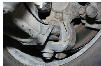
▲ Шаровая опора направлена пальцем вниз — вырвать такую сложно
