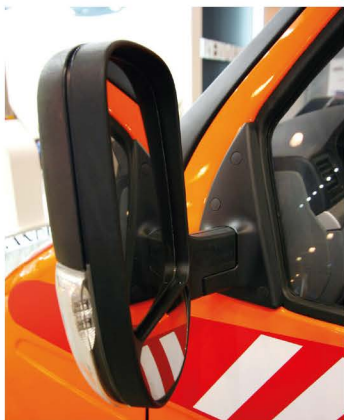
▲ Классический пример «три в одном»: основной плоский элемент, полусфера в нижней части корпуса для контроля бордюра и «поворотник»
