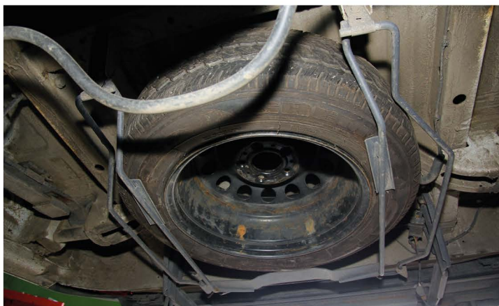
▲ Как и у большинства конкурентов запасное колесо цельнометаллического фургона крепится снизу
