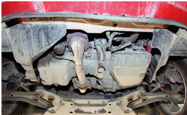
▲ Отсутствие крепкой защиты моторного отсека облегчает обслуживание машины, но делает легкодоступным для камней двигатель и коробку
