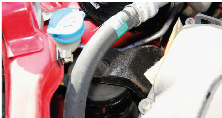
▲ «Уставшие» опоры силового агрегата один из явных признаков машины с большим пробегом. Уделите внимание вибрациям при работе мотора
