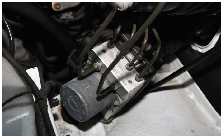
▲ Тормоза с антиблокировочной системой – следите за исправностью колесных датчиков
