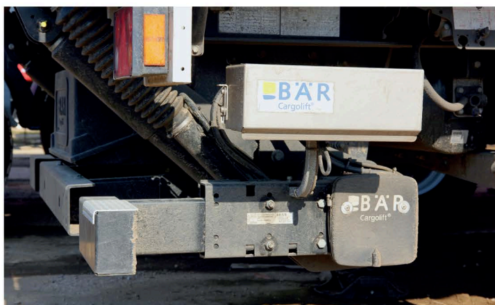
▲ Гидроборт имеет собственную силовую конструкцию, которая крепится к раме грузовика. Иногда для монтажа требуется изготовить оригинальную «лестницу»
