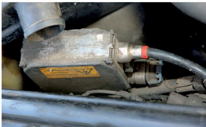
▲ Блок розжига ламп ксенонового света. Ксенон не является для данной машины штатным. Качество картинки, формируемой фарами, — под большим вопросом
