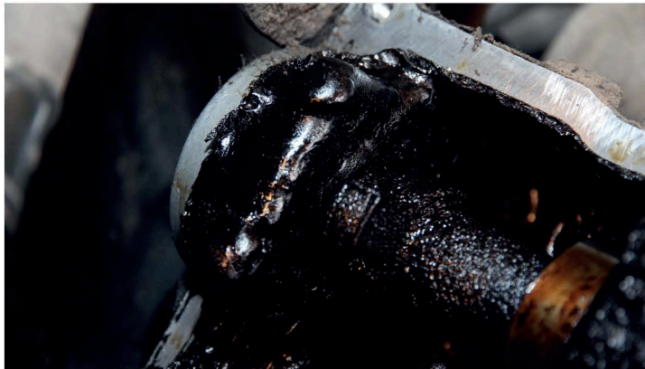
▲ Смола, скопившаяся под клапанной крышкой головки блока цилиндров, лучше всего говорит о причине выхода подшипников распредвала из строя
