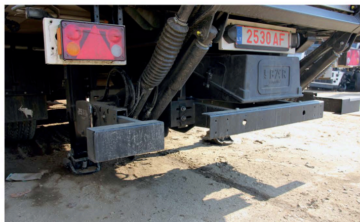
▲ В ряде случаев при применении гидробортов большой грузоподъемности к раме крепят опорные «лапы», которые разгружают заднюю подвеску грузовика
