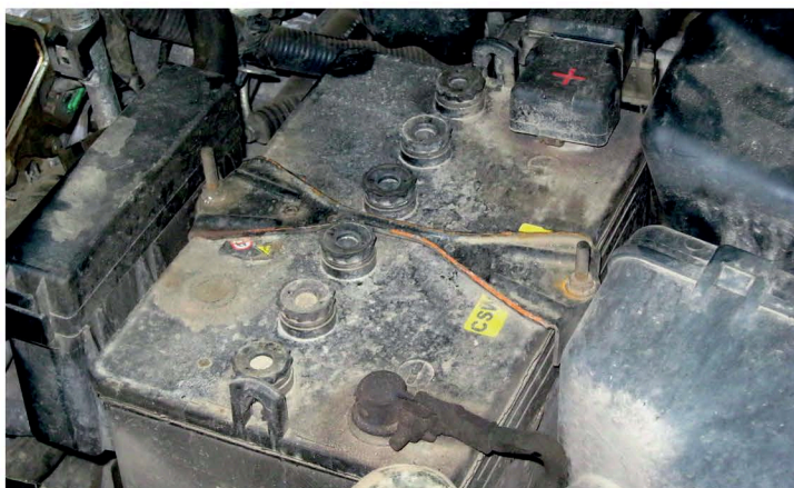
▲ Аккумуляторы с пробками позволяют легко и просто проверить уровень электролита в банках и при необходимости довести его до нормы
