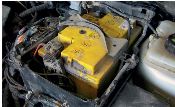
▲ На ряде легковых автомобилей конструкторы прячут аккумулятор в бокс. При «потере» его крышки аккумулятор загрязняется и происходит его саморазряд
