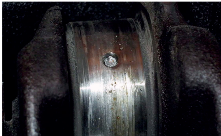
▲ Из-за сухого трения металл вкладыша, в буквальном смысле слова, закупорил масляную магистраль коленчатого вала
