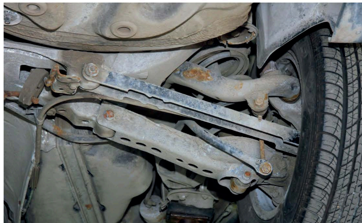
▲ Отменная управляемость и адекватное поведение машины в сложных дорожных условиях – отчасти заслуга многорычажной задней подвески
