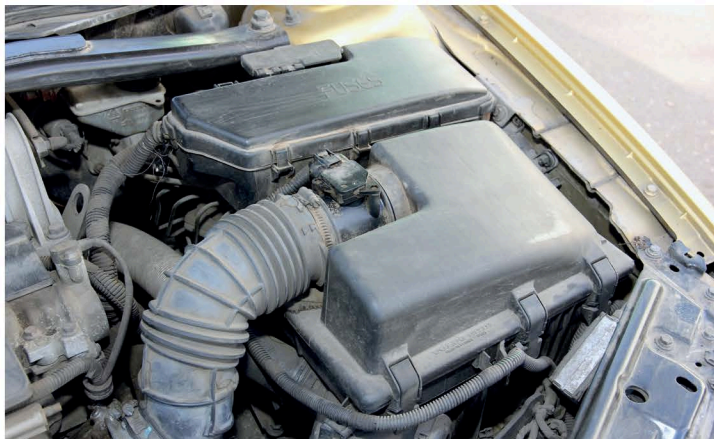
▲ Крышка корпуса воздушного фильтра на защелках. Замена фильтроэлемента не вызовет сложностей. Главное, чтобы фильтр имел правильную геометрию
