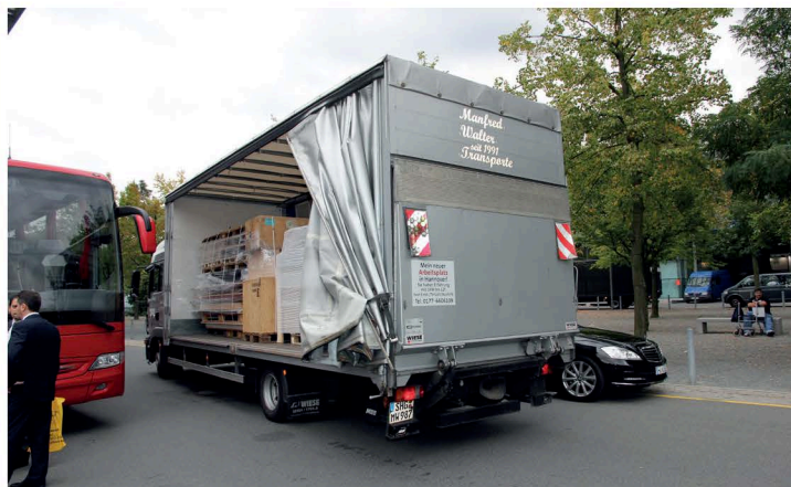
▲ Гидроборт может монтироваться не только на грузовики с жестким фургоном. Он актуален и для машин, имеющих возможность боковой разгрузки
