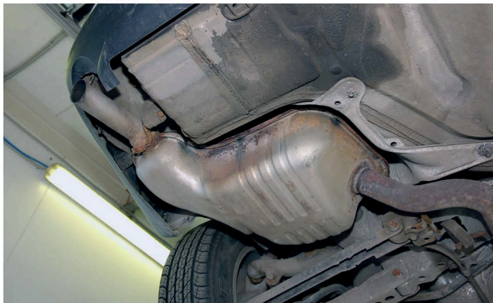
▲ На системе выпуска шведы не экономят, поэтому глушитель долго сопротивляется коррозии даже в просолённых реагентами мегаполисах
