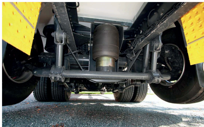
▲ Прежде чем начать использовать гидроборт, водитель обязан опустить дополнительную ось грузовика и тем самым обеспечить лучшую устойчивость машины
