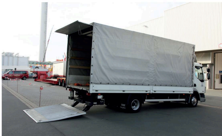
▲ Гидроборт берет груз от самой земли. Опорная поверхность должна быть ровной. В противном случае возможна деформация силовых элементов
