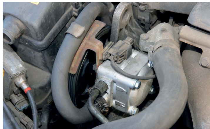
▲ Отсутствие потеков гидравлического масла говорит об исправном состоянии агрегатов. В противном случае проводите проверку и диагностику
