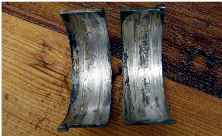
▲ Вкладыши, изношенные в результате масляного голодания. Причина – закупоривание маслоприемника смолами
