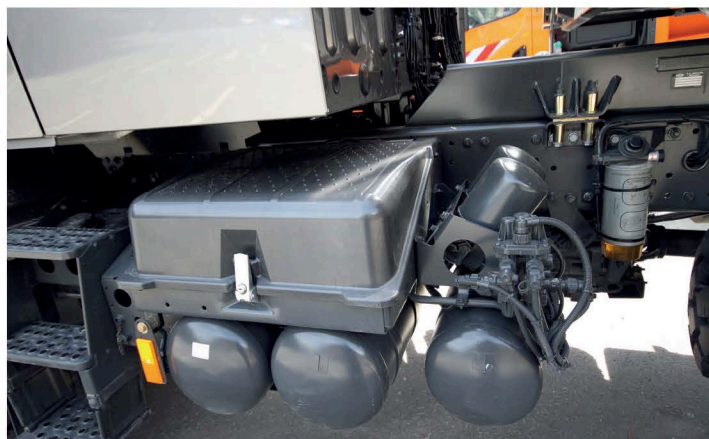
▲ Батареиный блок грузовика. Специальный корпус с легкосъемной крышкой оберегает батареи от воздействия атмосферных осадков и летящей с дороги грязы
