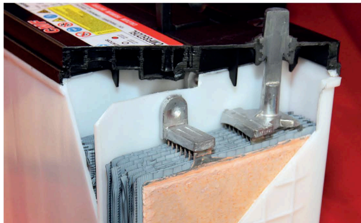
▲ Корпус из белого пластика позволяет визуальнo контролировать уровень электролита в аккумуляторной батарее
